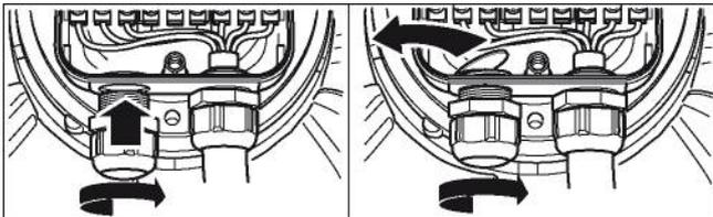
Abb. 4: Durchbruch Kabelverschraubung
